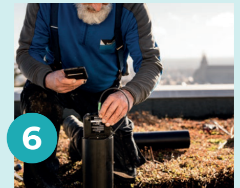
6 Elektronikgerät im Schacht platzieren und Abdeckung aufsetzen.
